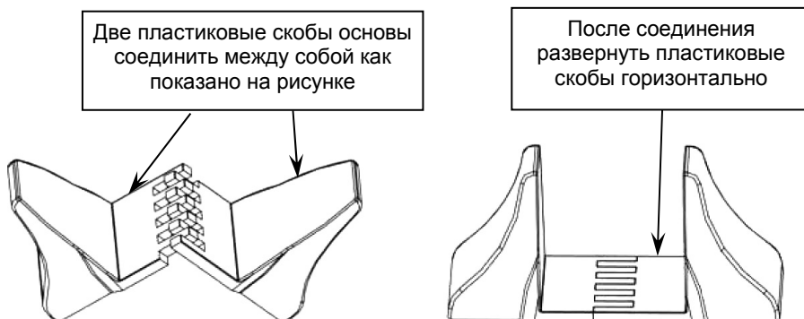
Рисунок 3 - Сборка пластиковых основ для вертикальной установки изделия.
